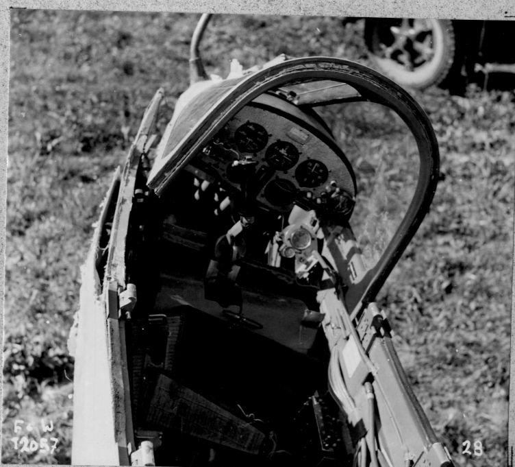
28 Innenansicht der defekten Pilotenkabine
