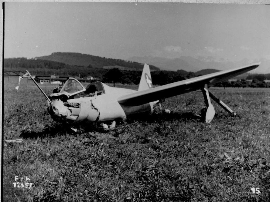
15 Zertrümmerte Kabine, eingeknicktes Bugfahrwerk, linkes Fahrwerk noch an Flügel
