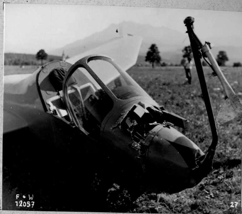
27 Zerstörter Kabinenvorderteil mit verbogener Halterstange für den Kolsmann-Anstellwinkelgeber und bewegliches Staurohr
