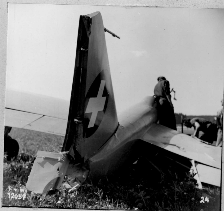
24 Zerstörtes Heck und rechte Trimmklappe
