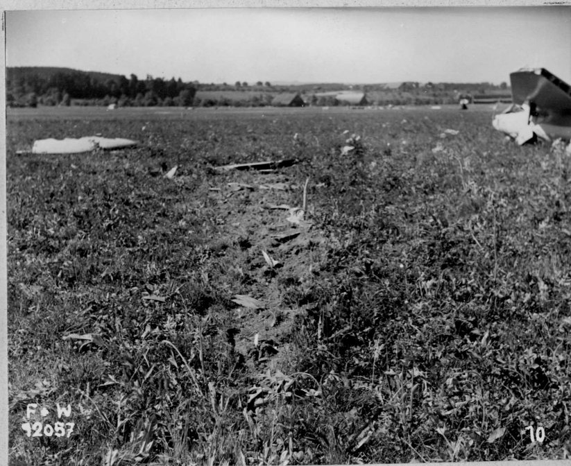
10 Spur des rechten Flügels, hervorgerufen beim Auseinanderreißen
