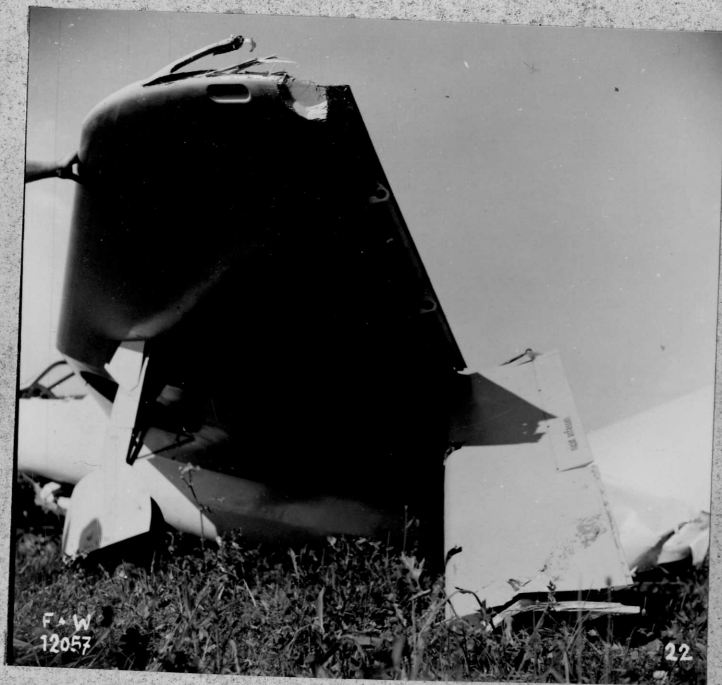
22 Beschädigter linker Randbogen und abgerissenes linkes Querruder
