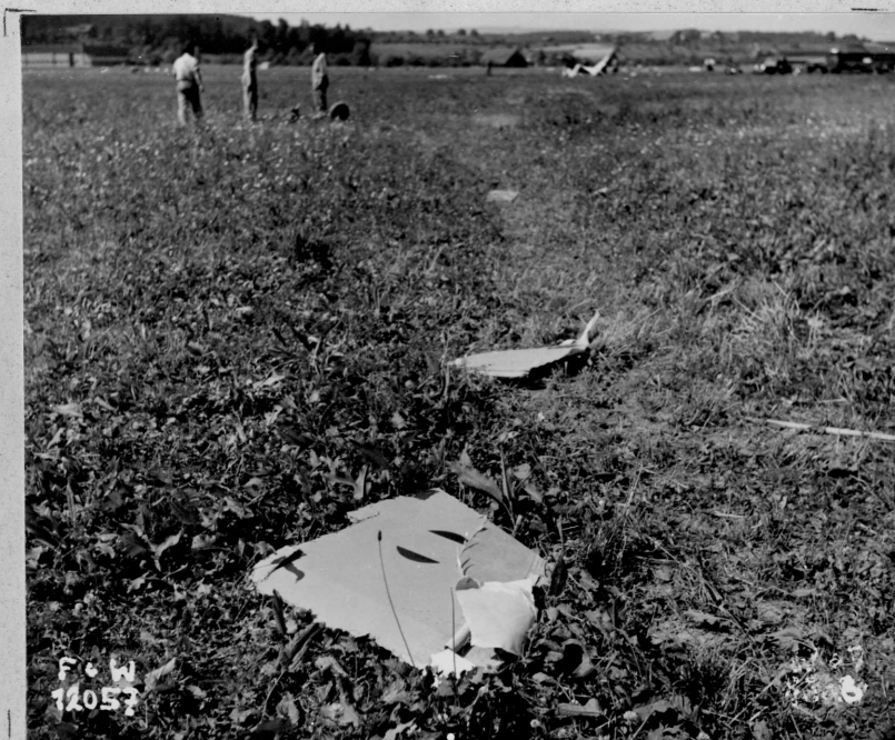
6 Stücke der Bepflung der Flügelunterseite rechts
