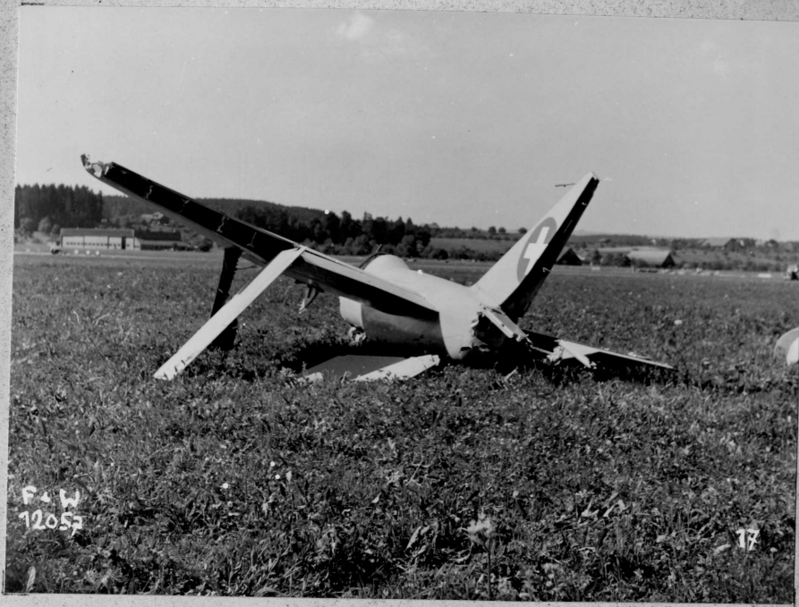
17 Ansicht von hinten links, abgerissenes linkes Querruder, zertrümmertes Heck, zerstörte rechte Tripanklappe, weggerissenes Seitenruder
