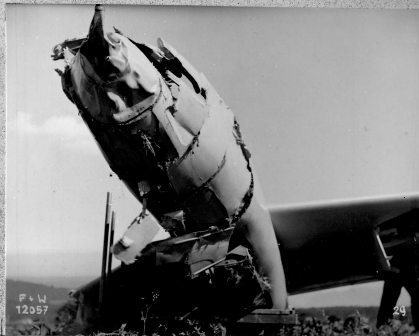
29 Zerstörter Kabinenvorderteil von unten gesehen
