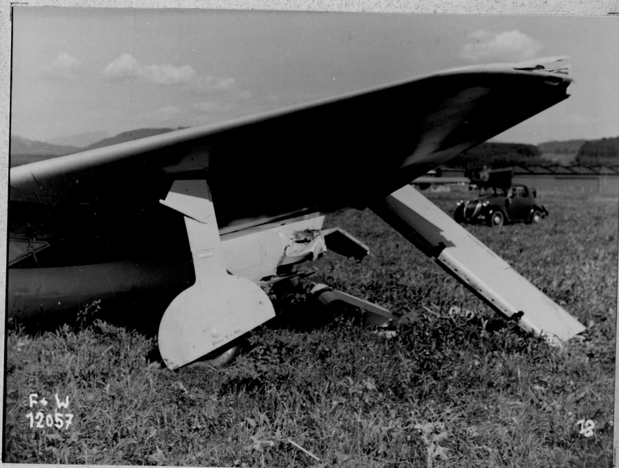
18 Ansicht von der linken Seite, intaktes linkes Fahrwerk, abgerissenes linkes Querruder
