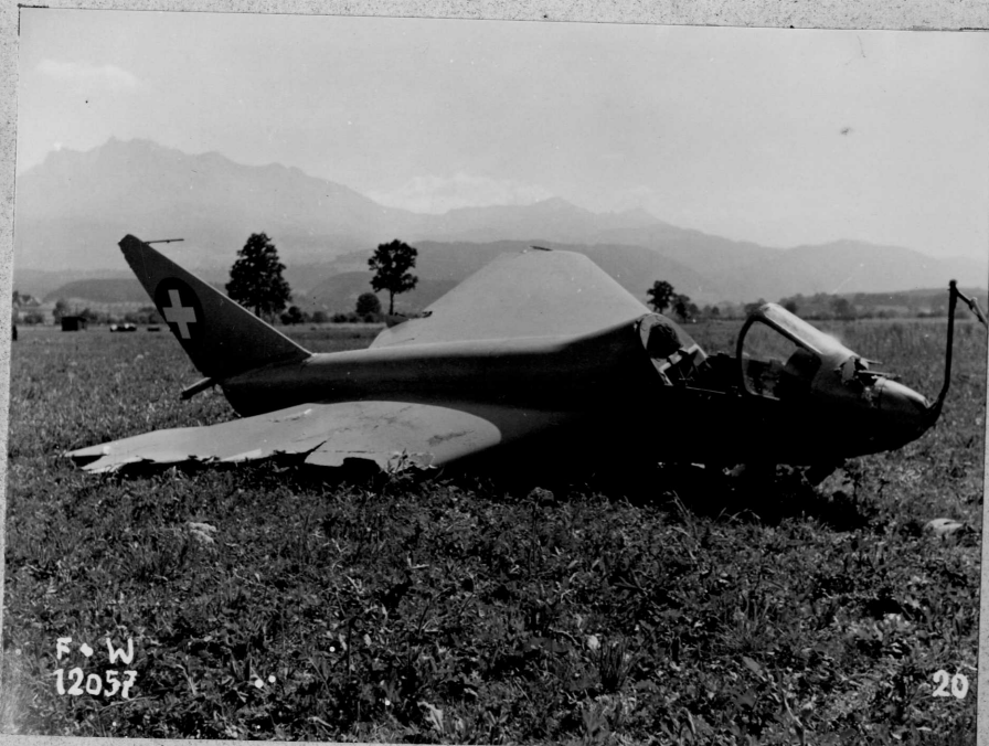
20 Ansicht von vorne rechts, zerstörter rechter Flügel, Kabine rechts weniger beschädigt als links
