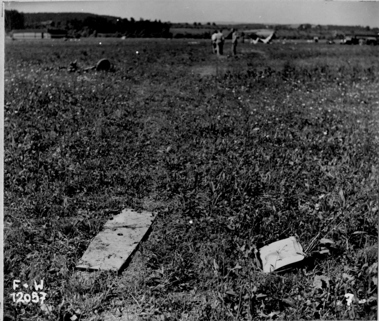
7 Rippe Nr. 6 des rechten Flügels und Teil der Bugradverschaltung
