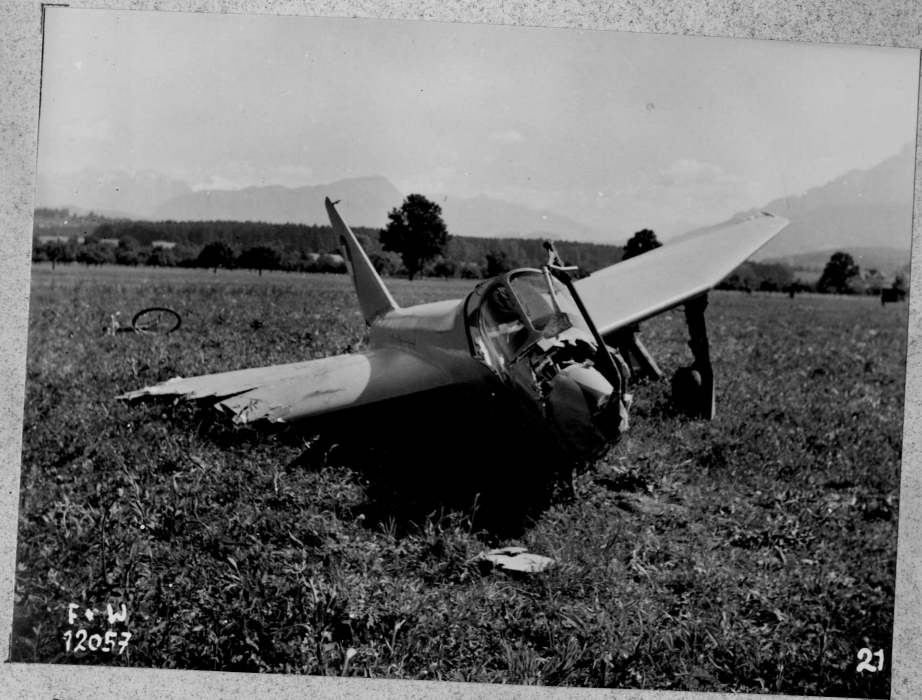
21 Ansicht von vorne. zerstörter rechter Flügel, beschädigte Kabine
