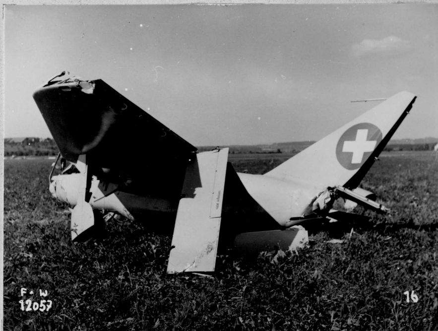
16 Ansicht von links hinten, beschädigter linker Randbogen, abgerissene linke Verwindungsklappe, zertrümmertes Heck, abgerissenes Seitenruder
