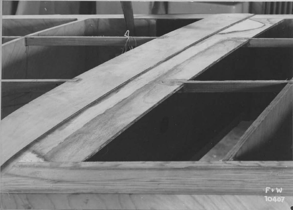
Haut-Verbindungsflansch an der Flügel-
