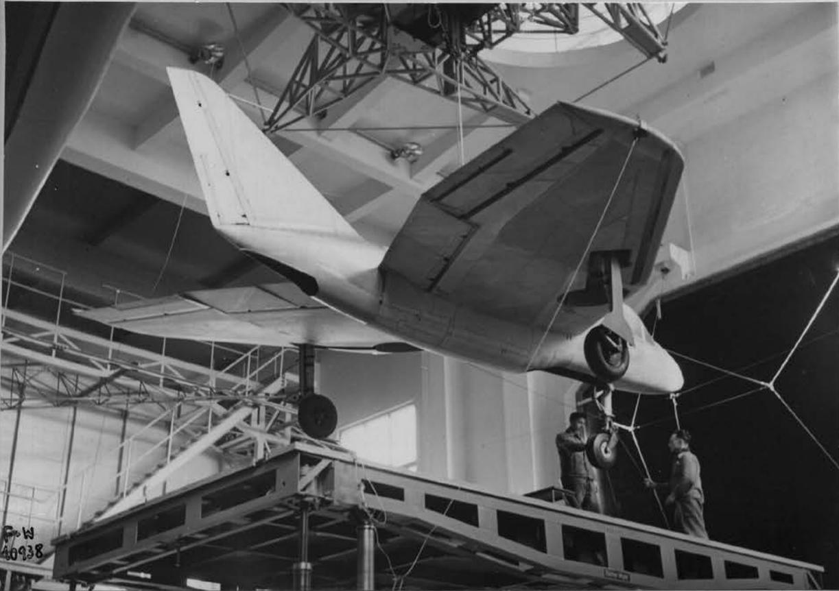
Gleiter komplett mit Leitwerk, ohne Stoffüberzug. Austrittskanten vor Klappen und Rudern durch Resocelstreifen verstärkt.
