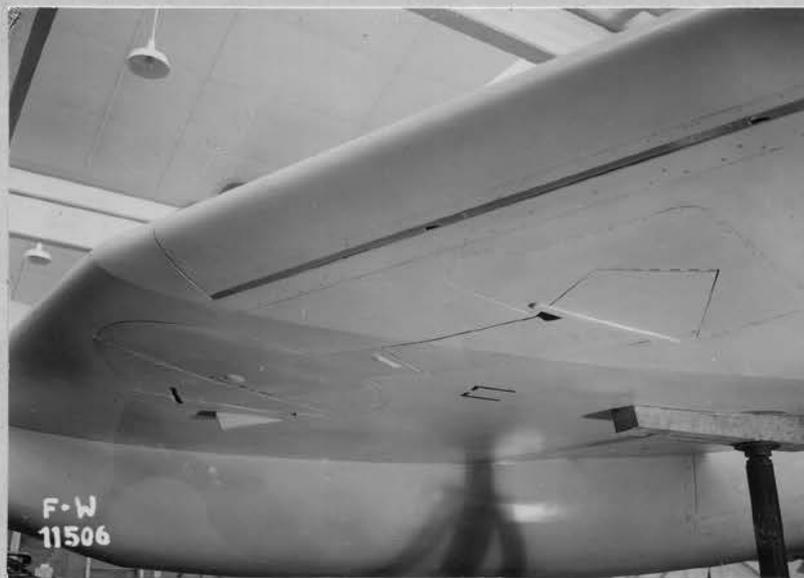
Fahrwerk im Flügel eingefahren
