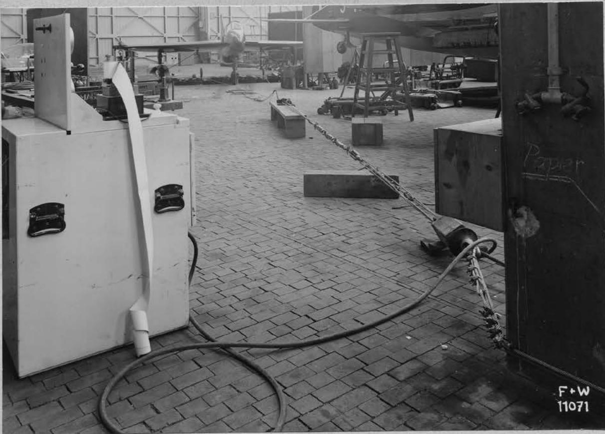
Klinken-Standversuch mit Schrägzug nach unten.
